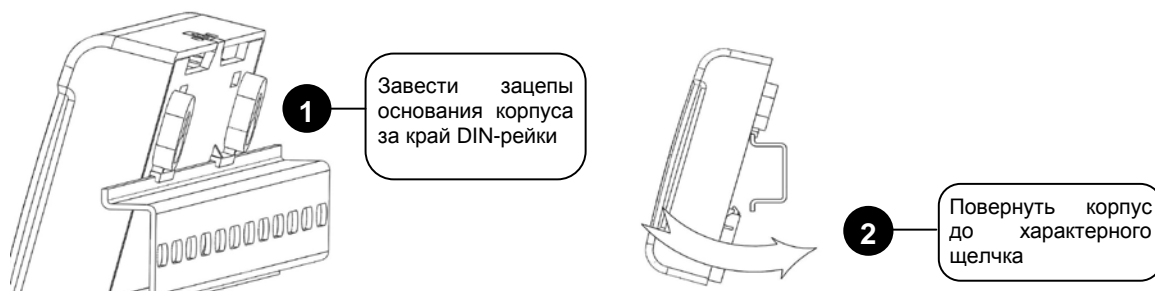
Рисунок 4. Монтаж прибора на DIN-рейку
