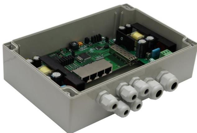
Рисунок 3.1.2 - PSW-1 - вид внутри
