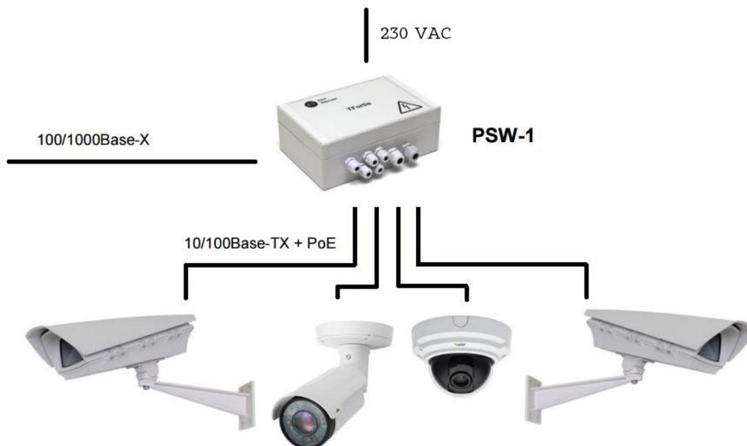
Рисунок 1.1 - Схема подключения PSW-1 по оптике
