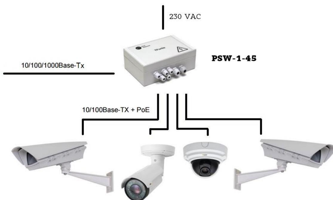
Рисунок 1.2 - Схема подключения PSW-1-45 по меди
