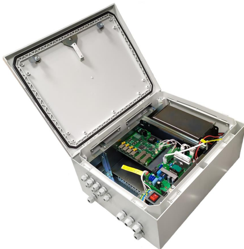
Рисунок 3.1.2 - PSW-2G+UPS-Box - вид внутри
